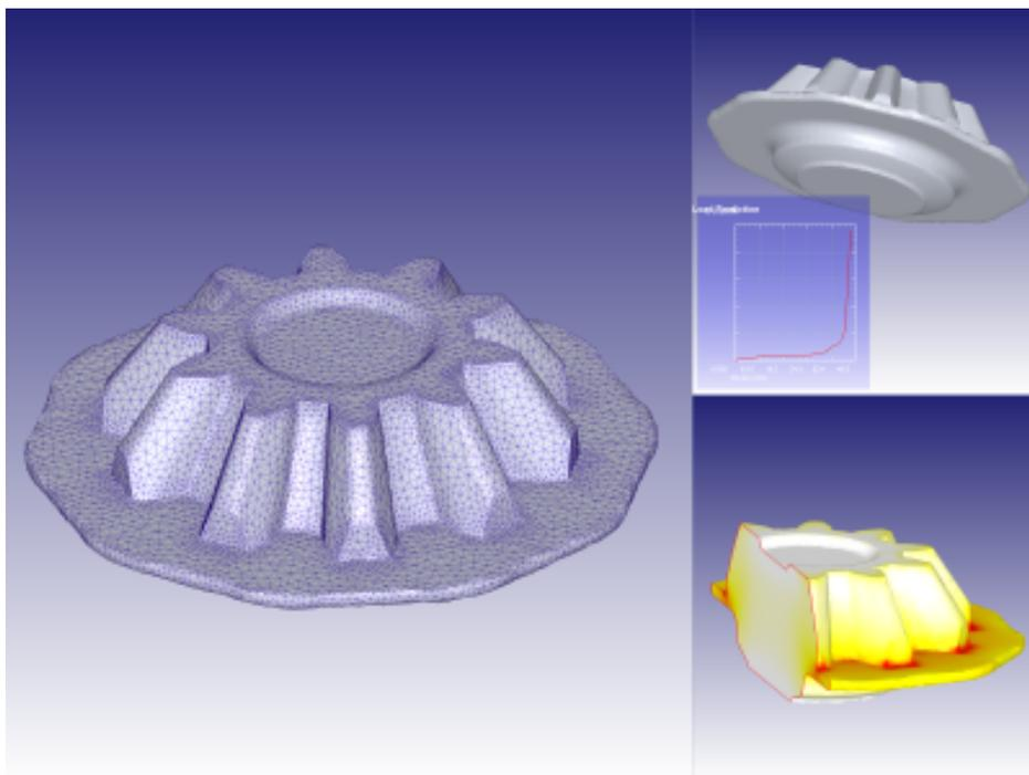
*DEFORM-3D включает в себя многофункциональный постпроцессор. На рисунке сверху показана сетка конечных элементов, форма поковки после формовки, график потребного усилия, эффективная деформация и форма сечения поковки. При помощи постпроцессора DEFORM 3D легко сравнивать результаты моделирования с незначительно различающимися параметрами.*
