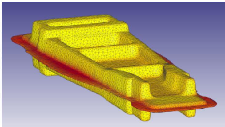
Основанные на методе конечных элементов, программные продукты DEFORM доказали свою эффективность и точность более чем двадцатилетним применением их на различных предприятиях. Мощный решатель системы способен анализировать течение металла и температурные показатели заготовки и инструмента при деформациях любой величины с очень высокой точностью.
