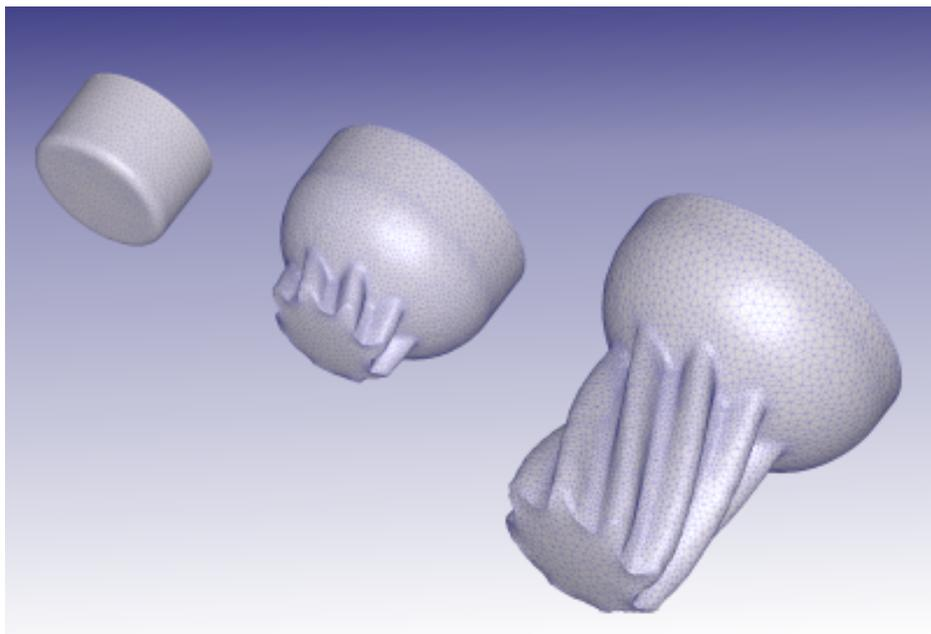
*DEFORM позволяет осуществлять моделирование процессов получения деталей, не требующих последующей механообработки. Косозубый зубчатый профиль, представленный на рисунке сверху, получают способом холодного выдавливания. Во время разработки технологического процесса этой детали применялось моделирование в программном комплексе DEFORM 3D, что позволило сэкономить средства необходимые для проведения многочисленных предварительных экспериментов.*
