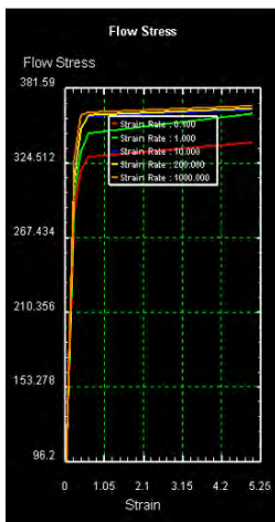
Рисунок 3 – Кривые пластического течения при T=800^{\circ}\text{C}
