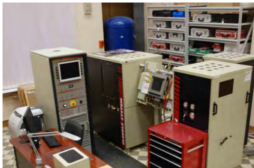
Рисунок 1 – Внешний вид комплекса Gleeble-3800
