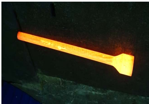
Рисунок 5 – Фотография поковки под штамповку в процессе транспортировки от печи
