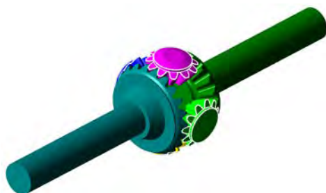
Рисунок 2 – Твердотельная модель фрагмента картера моста в сборе
