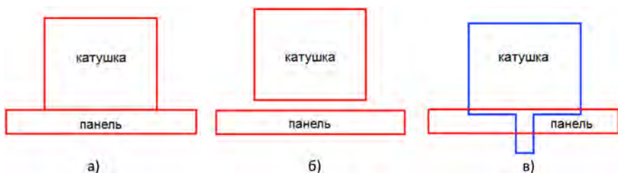
Рисунок 2 - Варианты размещения компонентов сборки во FlowVision: а) – с контактом; б) – с зазором; в) – с перекрытием
