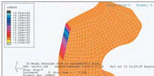
Рис. 4. Фрагмент резинового уплотнения (ABAQUS) с приложенным к нему давлением из FlowVision. Режим движения штока со скоростью 0,8 м/с
