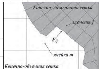
Рис. 1. Отсечение конечно-объемной ячейки конечно-элементной сеткой
