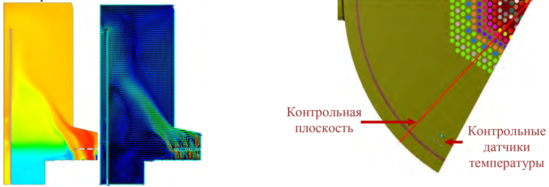
Рис. 6 – Поля температуры и скорости в контрольной плоскости
