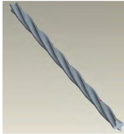
Рисунок 6. Трехмерная модель крестообразного твэла
