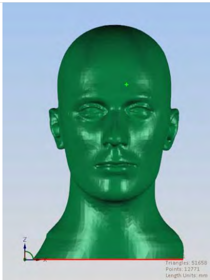
Сетчатая модель на основе облака точек
