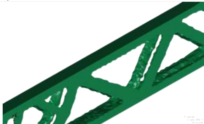
Первоначальная грубая сетка (после топологической оптимизации)
