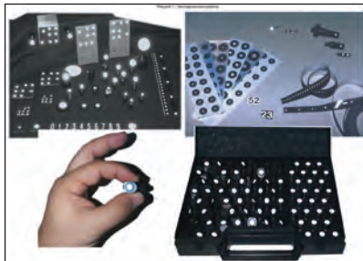
Рис. 2. Примеры маркеров со светоотражающим покрытием
