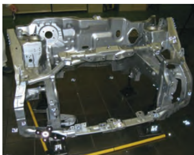
Рис. 13. Измерение кузовной части
