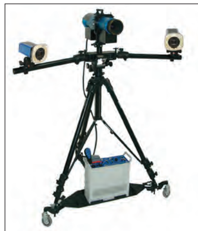
Рис. 9. Проектор Pro-SPOT и камеры V-STARS/Dynamo
