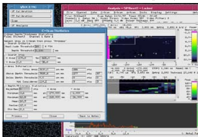
Рис. 4. Боковая стенка хранилища топлива. Зона уторного шва. Номинальная толщина 13,5 мм. Имеются участки с минимальной остаточной толщиной 3,6 мм
