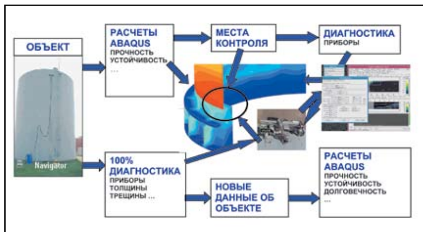
Рис. 2. Схема комплексного подхода к исследованию поведения конструкции
