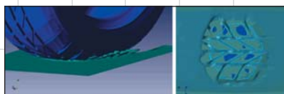
Аквапланирование автомобильной шины (пример задачи на взаимодействие «жидкость — конструкция», ABAQUS + FlowVision)
