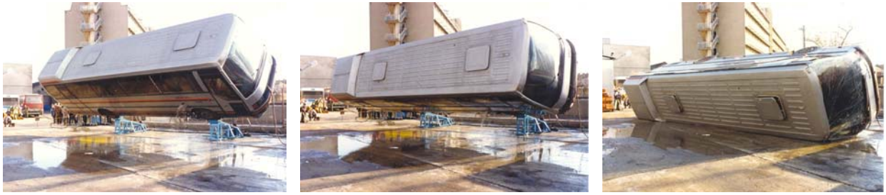
Рисунок 5 – Испытания автобуса по Правилам ЕЭК ООН №66
