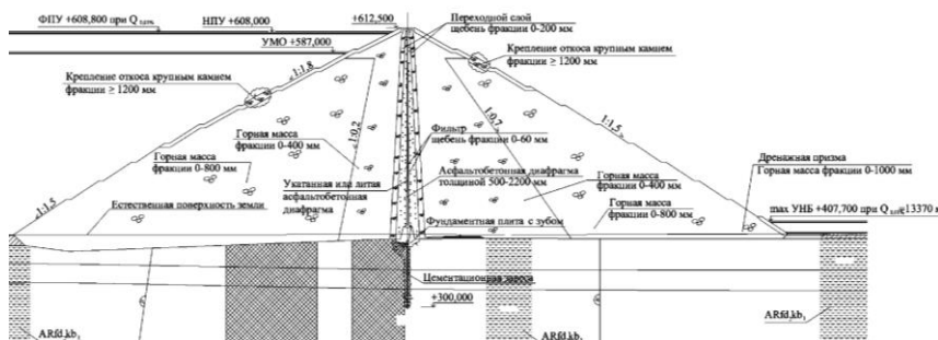
Рис.1. Варианты 1.1 и 1.2 Канкунской плотины с укатанной и литой диафрагмами
