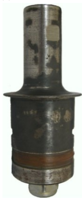
Рис. 1. 1/2 -волновой преобразователь продольных колебаний
