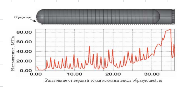
Рис. 13. Эквивалентные напряжения по Мизесу вдоль центральной образующей от верхней точки колонны до фундамента. Время t=1,5 с. P_{\phi} = 50 КПа
