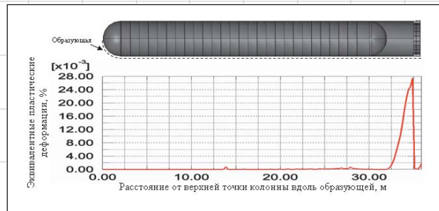
Рис. 14. Пластические деформации вдоль центральной образующей от верхней точки колонны до фундамента. Время t = 1,5 с. P_{\phi} = 50 КПа
