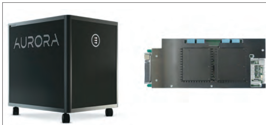
Рис. 2. G-Station шасси и вид одного вычислительного узла. Размеры вычислительного блока (В×Ш×Г) — 70×65×80 см
