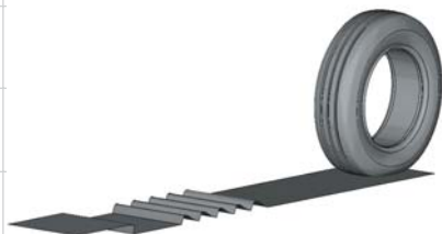
Рис. 12. 3D-модель, импортированная в ABAQUS/Explicit из ABAQUS/Standard
