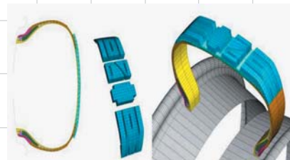
Рис. 16. Моделирование протектора посредством периодического сектора
