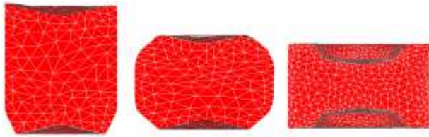
Рис. 2 Объемная сетка конечных элементов
