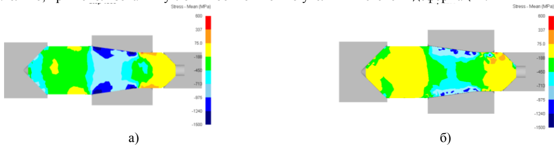
Рис. 6 Средние напряжения а) радиусный б) угловой инструмент
