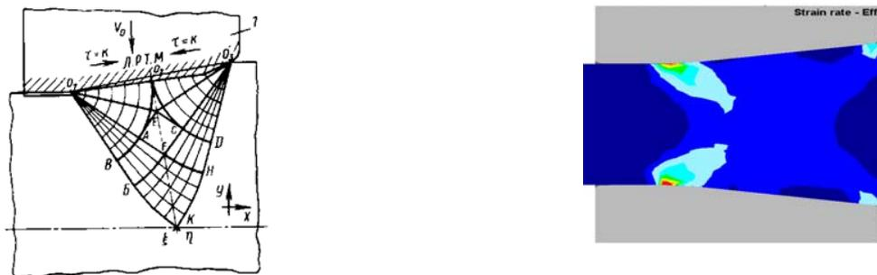
Рис. 3 Очаг деформаций в продольном сечении: а – поля линий скольжения; б – очаг деформации, построенный методом конечных элементов.
