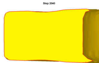
Рис.5 Сечение кольца после раскатки
