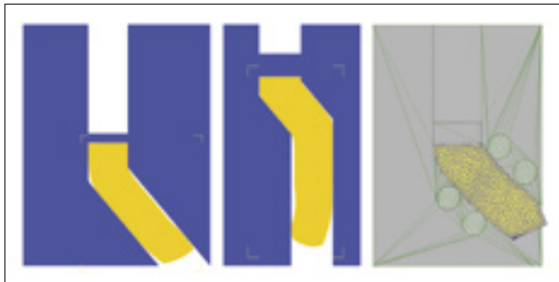
Рис. 1. Прессование заготовок в матрицах различных конструкций: а — угловая матрица; б — ступенчатая матрица; в — матрица с роликами
