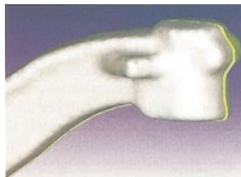
Рис. 4. Кованая балка моста до термообработки (белым) и после (желтым)
