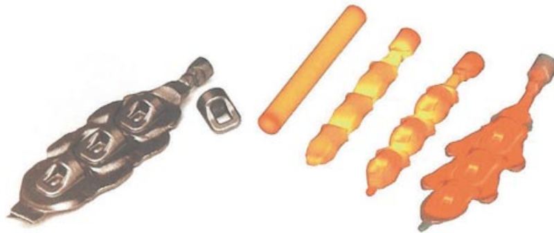
Рис. 3. Благодаря моделированию процесса получения проушины баллона для сжатого воздуха процент брака удалось снизить с 11 до 3%
