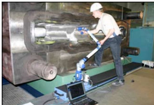
Рис.4. Контроль гравюры длинномерного штампа при помощи КИМ FaroArm P08-05, установленной на прецизионный рельс длиной 3 метра фирмы FARO Technologies
