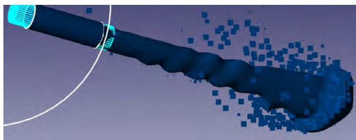
Рис. 3. Топливная струя ( d_{отв} = 0,3 мм, p = 500 бар)
