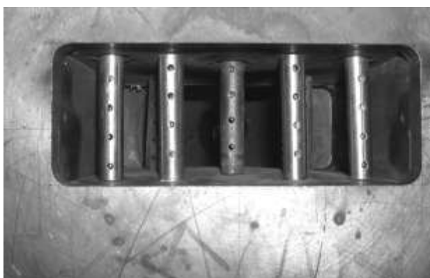
Рис.8. Выходное сечение газосборника МКС, расположенной в экспериментальном отсеке на стенде ВТИ.
