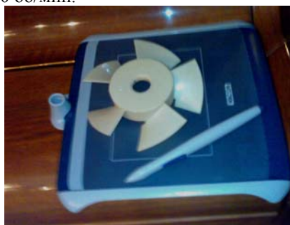
Рисунок 1- ротор с 5 лопатками
