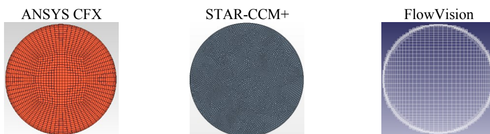
Рис. 2 – Фрагменты расчётных сеток
