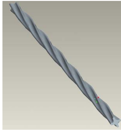
Рисунок 6. Трехмерная модель крестообразного твэла
