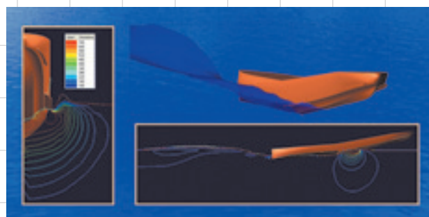
Рис. 13. Волнообразование, граница раздела сред, положение корпуса и распределение давления в области редана модели на скорости глиссирования 6,0 м/с, соответствующей «горбу сопротивления»
