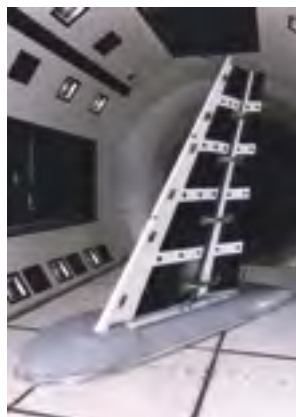
Рис. 1. Механизированное крыло в аэродинамической трубе [1]
