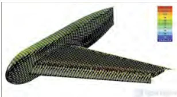
Рис. 6. Распределение скорости по поверхности модели
