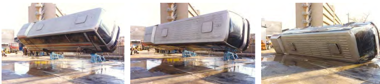
Рисунок 5 – Испытания автобуса по Правилам ЕЭК ООН №66
