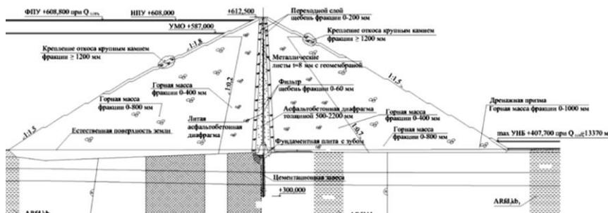
Рис. 3. Вариант 3 Канкунской плотины с составной диафрагмой
