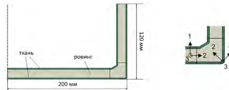
Рис. 2 - Пултрузионный швеллер. Слева - половина сечения швеллера с характерными размерами, справа - материальные направления в ровинге и ткани
