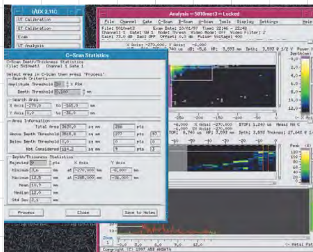
Рис. 5. Боковая стенка хранилища топлива. Зона уторного шва. Номинальная толщина — 13,5 мм. Обнаружены участки с минимальной остаточной толщиной всего 3,6 мм
