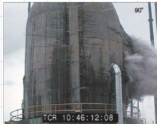
Рис. 3. Прототип ПНЖР в масштабе 1:4 до разрушения (слева) и во время разрушения (справа)
