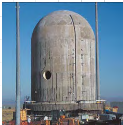
Рис. 3. Прототип ПНЖР в масштабе 1:4 до разрушения (слева) и во время разрушения (справа)
