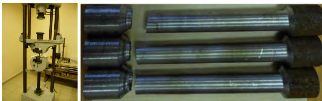
Рисунок 3. а) машина УММ-20; б) разрушенные образцы
