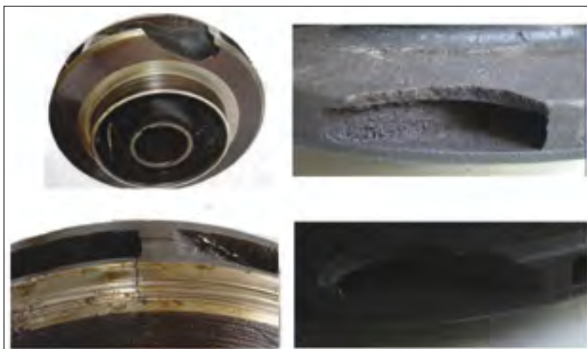
Рис. 1. Скол и усталостная трещина на колесе насосного агрегата
