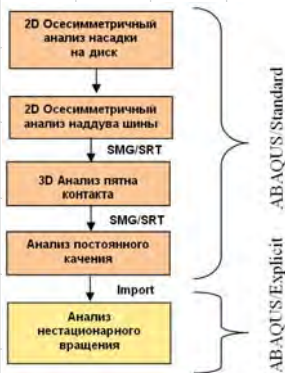
Рис. 1. Блок-схема комплексного подхода ABAQUS к анализу поведения шин (SMG — Symmetric Model Generation, SRT — Symmetric Results Transfer)
