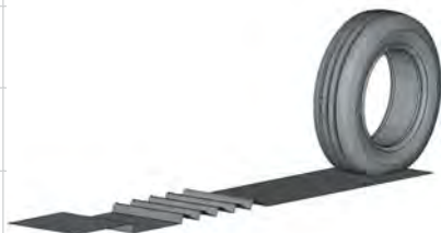
Рис. 12. 3D-модель, импортированная в ABAQUS/Explicit из ABAQUS/Standard
