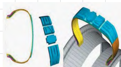
Рис. 16. Моделирование протектора посредством периодического сектора
