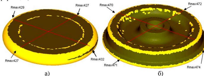
**Рис.3. Конфигурация поковки после осадки в плоских штампах с подвижным центрирующим кольцом (а) и после чистой штамповки (б)**
