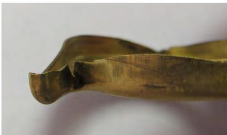
Рис. 2- Брак при изготовлении часового корпуса
