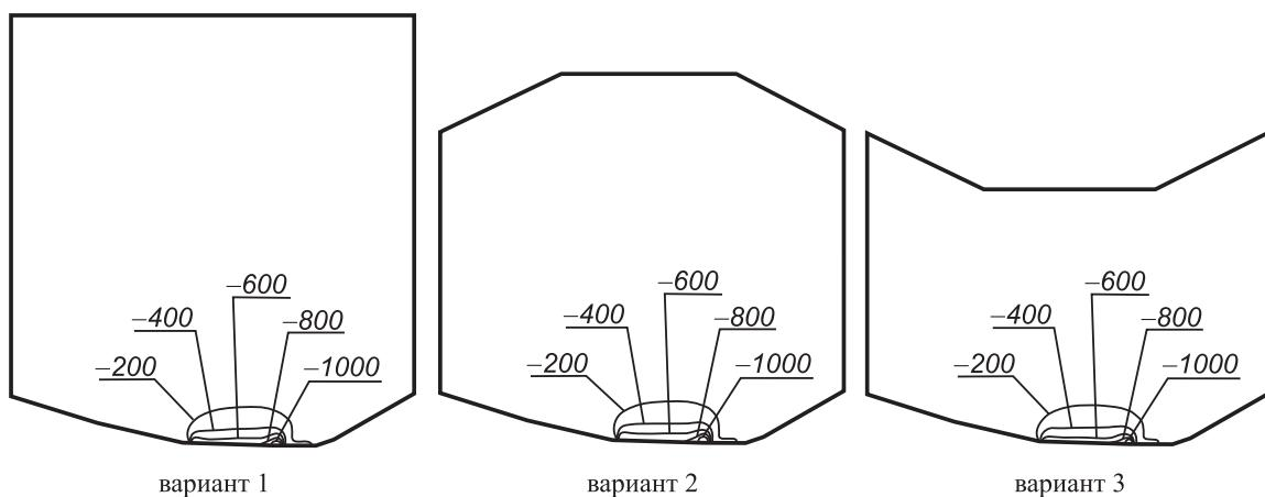
Рис. 2. Распределение сжимающих напряжений в контактной зоне волоки  $\sigma_3$ , МПа
