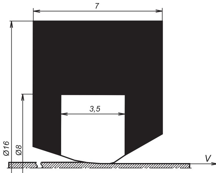
Рис. 1. Геометрия инструмента и заготовки в продольном сечении
