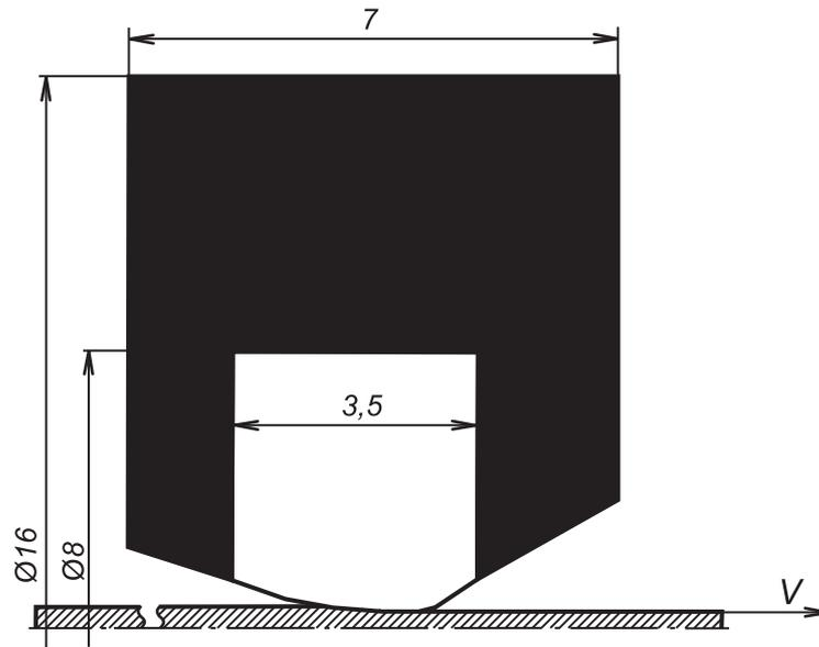
Рис. 1. Геометрия инструмента и заготовки в продольном сечении
