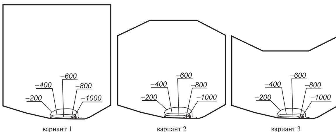
Рис. 2. Распределение сжимающих напряжений в контактной зоне волокна  $\sigma_3$ , МПа
