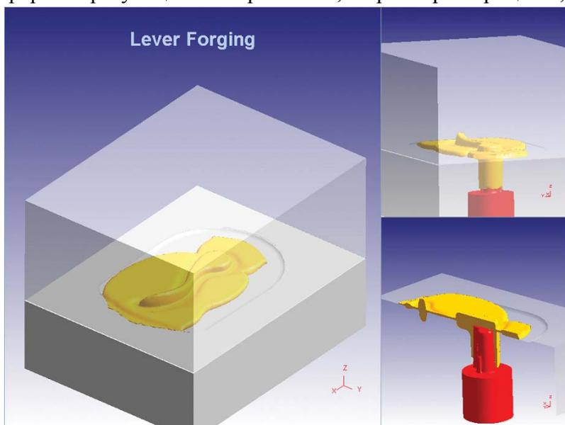
Рис.1 Горячая штамповка рычага
