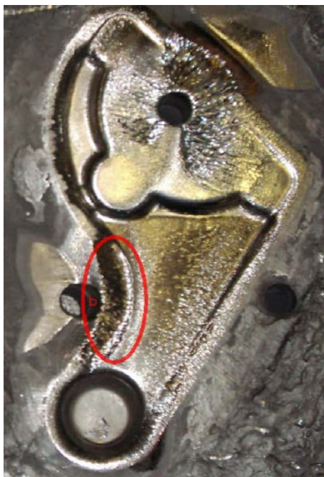
Рис. 6. Нижняя вставка черновой матрицы «базового» варианта после выхода из строя в связи с износом.
