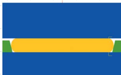
Рис. 5. Геометрия заготовки после осадки в кольцо
