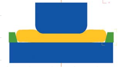
Рис. 6. Геометрия заготовки после разгонки
