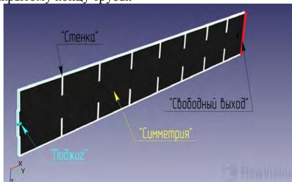
Рис. 2 – Расстановка граничных условий и расположение модификатора «поджиг»
