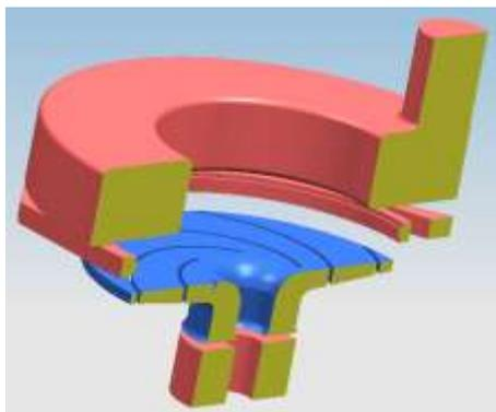
Рис.1. 3-D модель расчетной области центробежного насоса.
