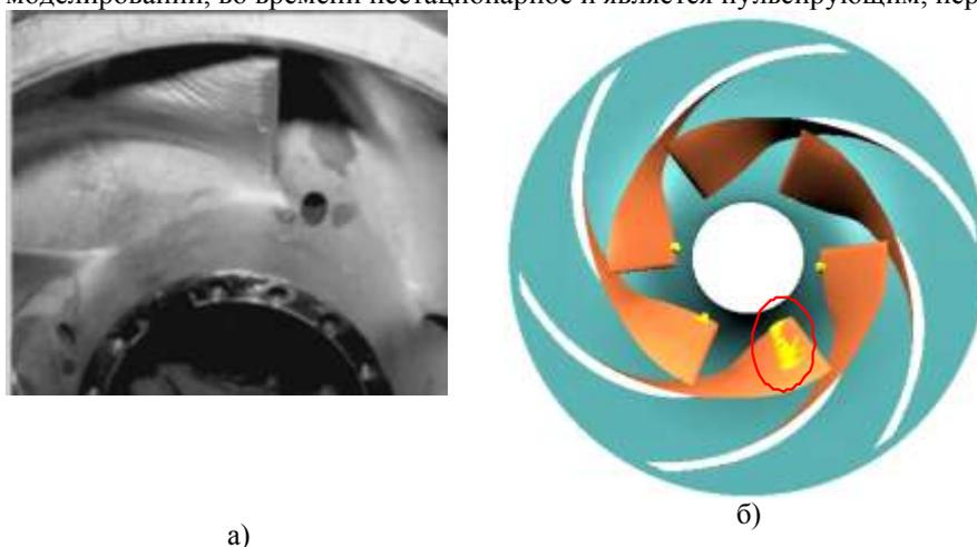
Рис.7. Рассмотрение явления кавитации в насосах. Места эрозионного износа в центробежном колесе (а), вид со стороны всасывания. Зоны давления, ниже давления насыщения (б), результат полученный во FlowVision.
