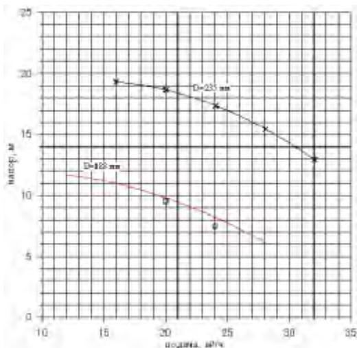
Рис.3. Сравнение теоретической напорной характеристики с результатами численного моделирования, при подрезке рабочего колеса.
