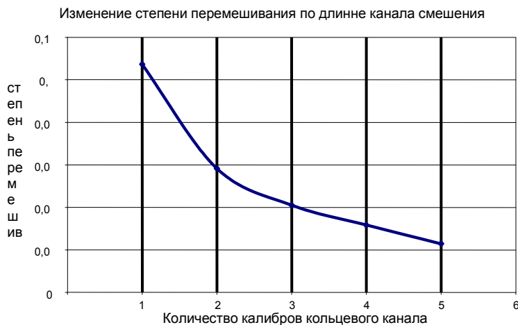
Рис.4. График зависимости степени перемешивания ТВС по длине канала смешения
