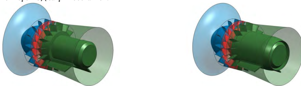
Рис. 4 – Вентилятор с открытым и закрытым электродвигателем.
