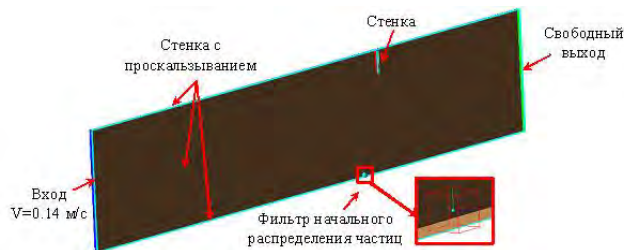
Рис. 1. Расстановка граничных условий и положение фильтра начального распределения частиц в расчетной области.
