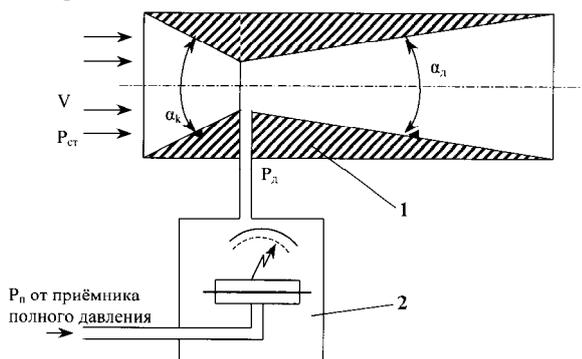
Рис. 1. Измеритель малых воздушных скоростей с трубкой Вентури:
