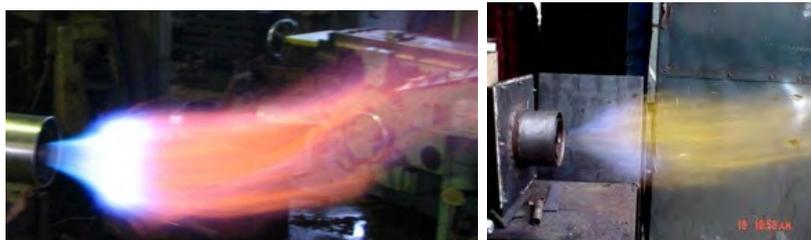
Рис.7. Эжекционная горелка. Эксперимент: 06.03.07. Новогиреево
